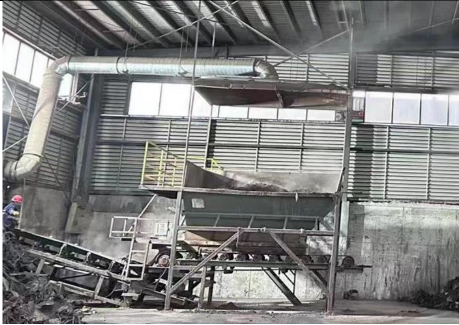
图 4-1 上料口废气收集现状
